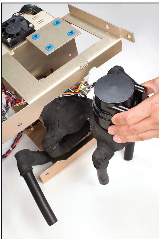
Obr. 8-31 Opatrně vyjměte směšovací pumpu (krok 5)
