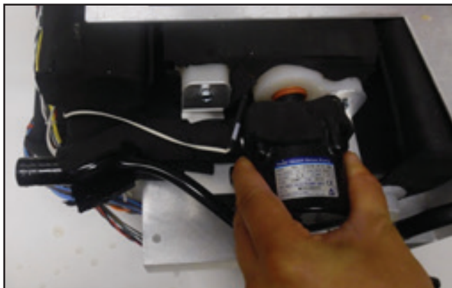
Obr. 8-47 Opětovná instalace pumpy (krok 6) (dva pohledy)
