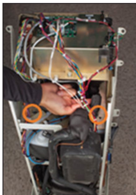
Obr. 8-17 Odstraňte dva šrouby (krok 2)
