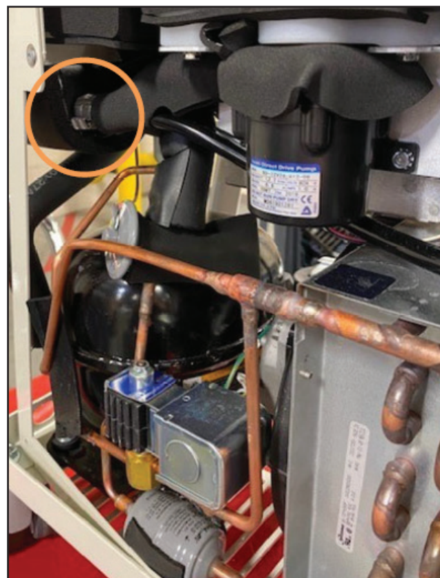
Obr. 8-22 Odpojte dvě svorky (krok 3 – pumpa DC)
