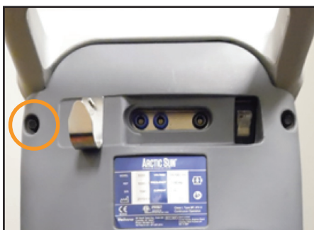
Obr. 8-72 Odstraňte šroub (krok 1)
