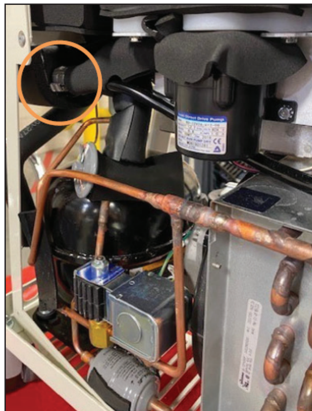
8-22. ábra Válassza le a két bilincset (3. lépés - Egyenáramú szivattyú)
