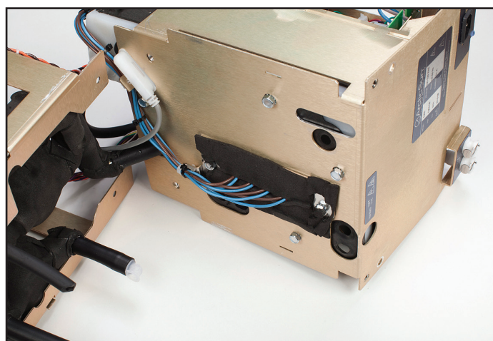
8-49. ábra Tartály és fűtőegység az eltávolítandó kábelkötegelők megjelölésével (2. lépés)
