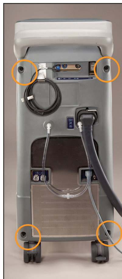
8-10. ábra Hátsó panel megjelölt eltávolítandó csavarokkal (2. lépés, balra)
