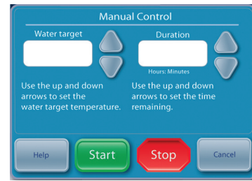
그림 1-10 수동 제어 패널(사용자가 주 정상 체온 또는 저체온 화면에서 수동 제어를 누르면 나타남)
