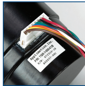
그림 8-32 연결되기 전 펌프 커넥터 그림(위), 연결되었지만 핀 1개가 노출되어 잘못 장착된 상태(왼쪽 아래) 및 올바르게 장착된 상태(오른쪽 아래)
