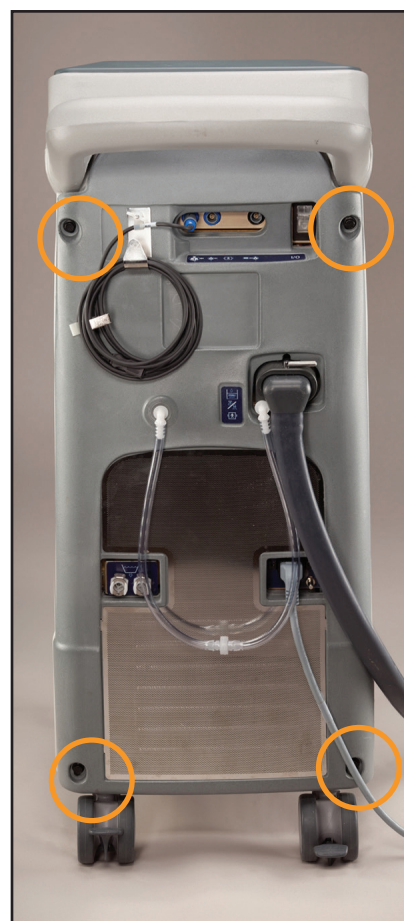
Obr. 8-10 Zadný panel s indikáciou skrutiek, ktoré sa majú odstrániť (krok 2, vľavo).
