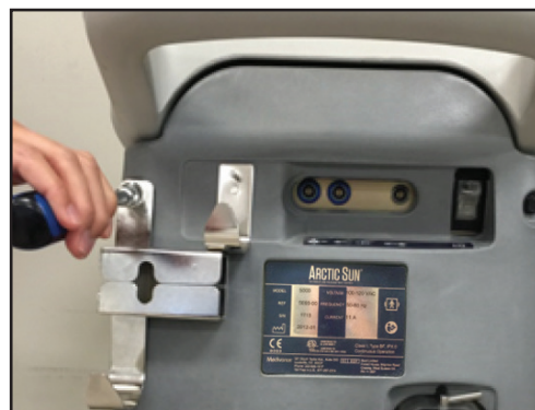
Obr. 8-73 Zaistite konzolu (krok 2).
