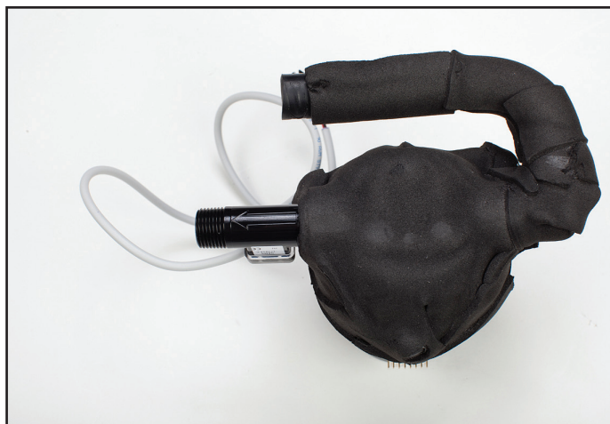
Obr 8-53 Prietokomer so šípkou, ktorá označuje smer prietoku; rovnaký smer ako výstup obehového čerpadla.
