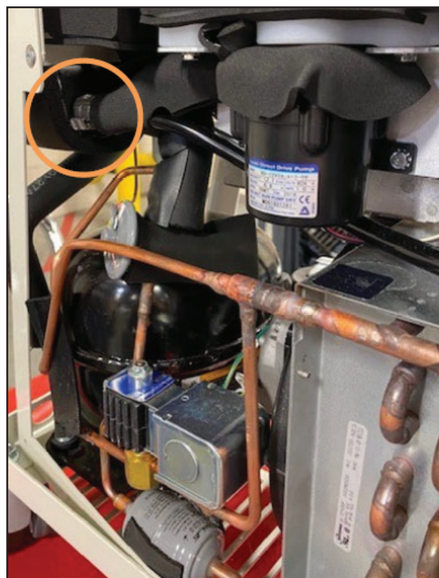
Obr. 8-22 Odpojte dve svorky (krok 3 – čerpadlo na jednosmerný prúd).
