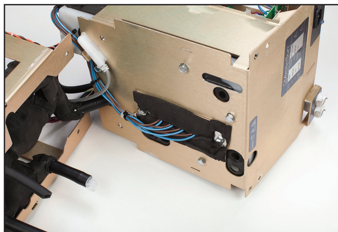
Obr. 8-49 Nádrž a ohrievač s uvedením, ktoré káblové pásky treba odstrániť (krok 2).
